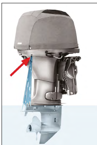
2 - Nei motori fuoribordo il getto d'acqua di raffreddamento deve essere continuo e abbondante.
