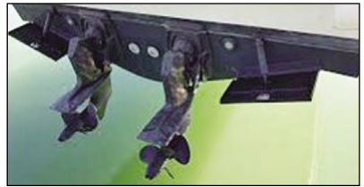
12 - Flaps montati su una barca con sistema di trasmissione entrofuoribordo.
