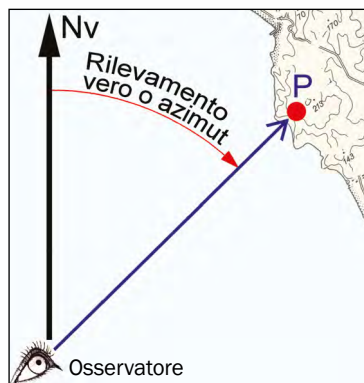
1 - Rilevamento vero (Rilv) o azimuth.
