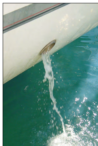
3 - Scarico con poco fumo e abbondanti fiotti d'acqua. Diversamente bisogna spegnere subito il motore.
