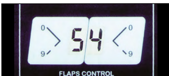
14 - Esempio di display che indica la regolazione dei flaps. I valori vanno da 0 (flaps completamente sollevati), fino a -9 (abbassati al massimo). In questa immagine, il flap di sinistra (-5), è leggermente più abbassato di quello di dritta (-4).
