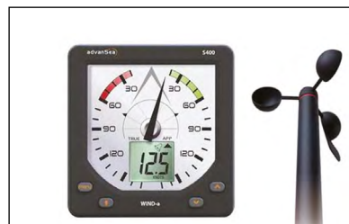
1 - La stazione del vento in testa d'albero (a destra) è composta da una girandola a coppette che ne misura l'intensità e da una banderuola che ne rileva la direzione rispetto alla prua. I dati sono riportati in uno schermo in pozzetto (a sinistra).
