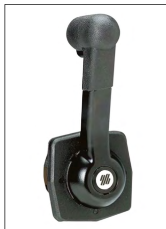
1 - Tipica manetta di un'imbarcazione a motore. È in posizione verticale, neutra.
