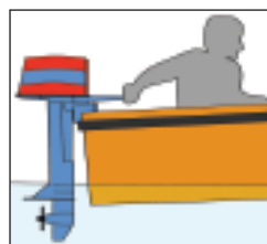
1 - Un secondo motore è considerato ausiliario quando è amovibile (fuoribordo) e di potenza non superiore al 20% di quella del motore principale.
