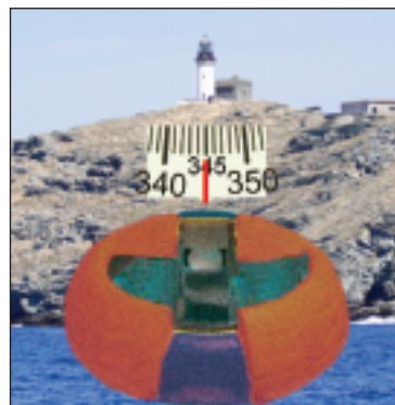
2 - Bussola portatile da rilevamento. Ne esistono di vari tipi. Sono in commercio anche binocoli con bussola incorporata che permette il rilevamento direttamente attraverso l'oculare.
